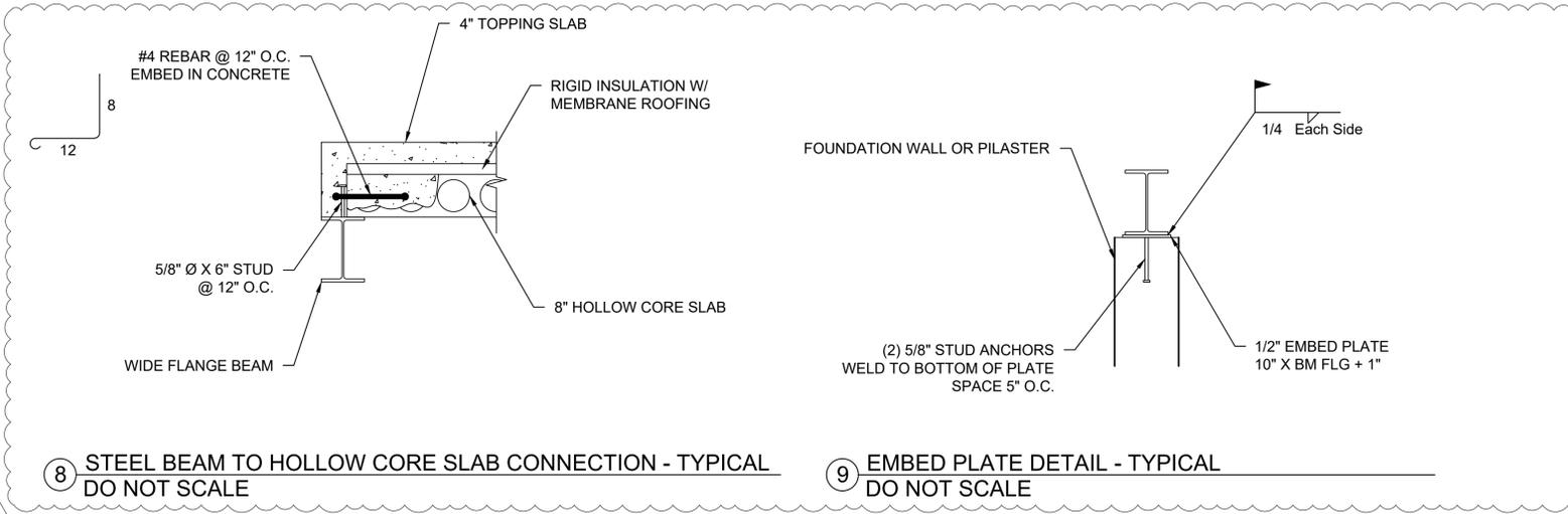
8 STEEL BEAM TO HOLLOW CORE SLAB CONNECTION - TYPICAL
